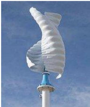
Figura 47. Rotore Savonius
